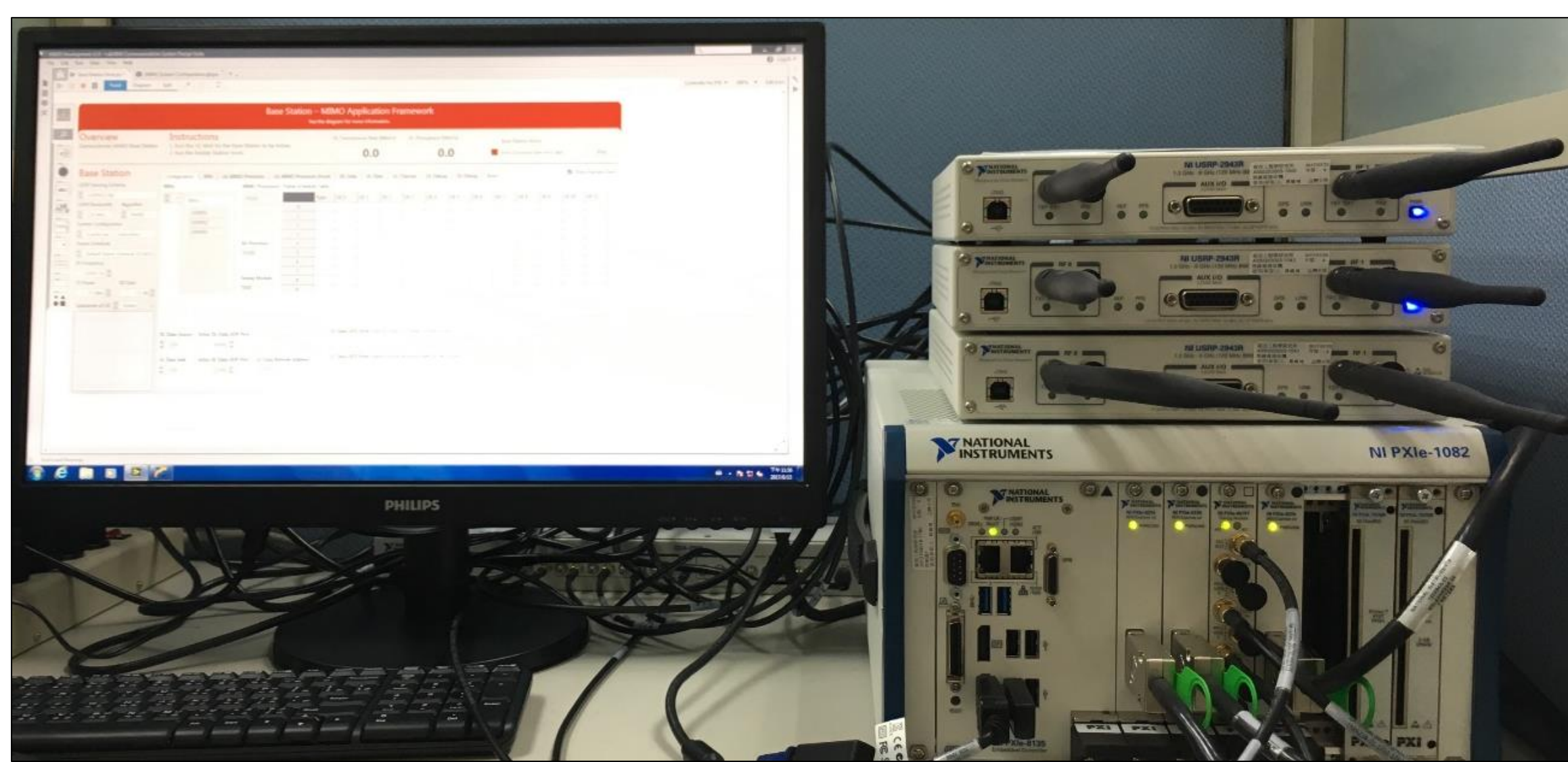
圖一:基地站MIMO模擬器，可建構8 Ports
